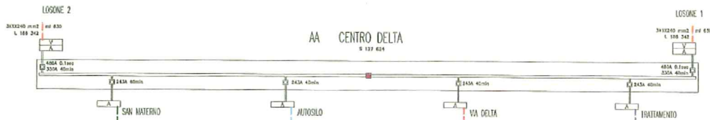
Figura 1: Schema della sbarra MT al centro MT (2 cavi in entrata e 4 in uscita)
