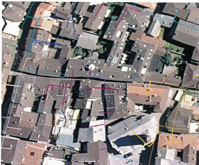
In base ai piani disponibili, in Contrada Maggiore mancano sottostrutture. Si prevede la posa di 2 tubi per la FO e di 2 tubi per la rete elettrica.
