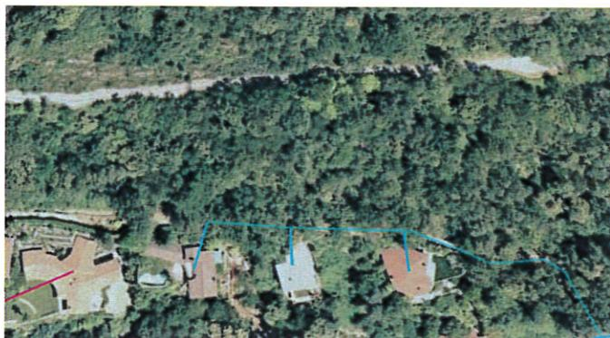
Sotto il sentiero Romano, nella prima parte, mancano sottostrutture. Anche in questo caso si prevede la posa di 1 tubo per la FO e la sostituzione del tubo per l'illuminazione pubblica e la posa di 1 tubo per la rete elettrica.
