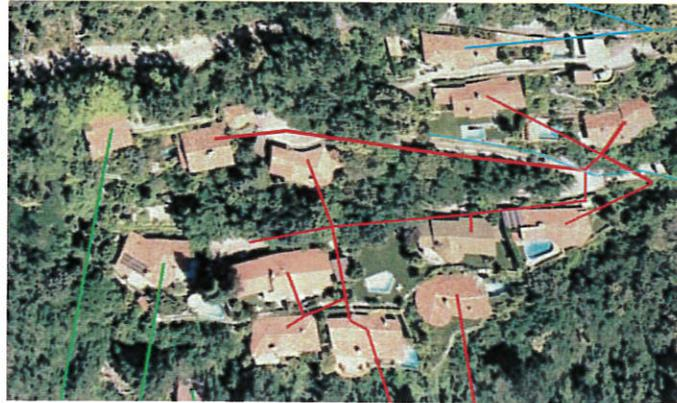
Si prevede la posa di un tubo per la FO e di 2 tubi per l'AEC sulla lunghezza di 220m, saranno posati anche 2 armadi di distribuzione BT.
