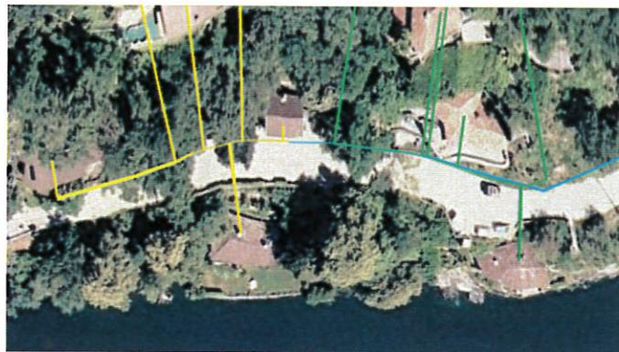
Si prevede la posa di un tubo di attraversamento e eventualmente di 1 tubo lungo il bordo della strada (100m) per la FO, nell'attraversamento saranno posati anche 2 tubi per la rete elettrica.
