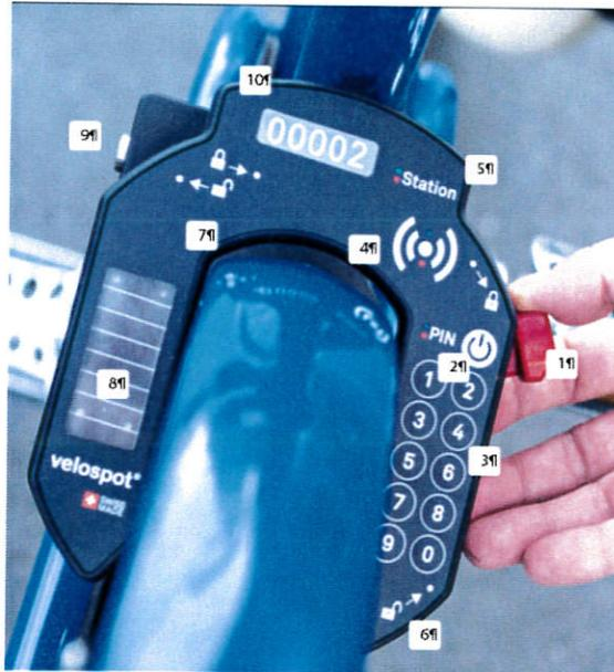
1. → Verrouillage (automatique à l'ouverture—manuel à la fermeture)¶
